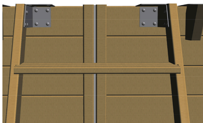
Figura 17 – Fijación de la escalera exterior sobre el vaso
